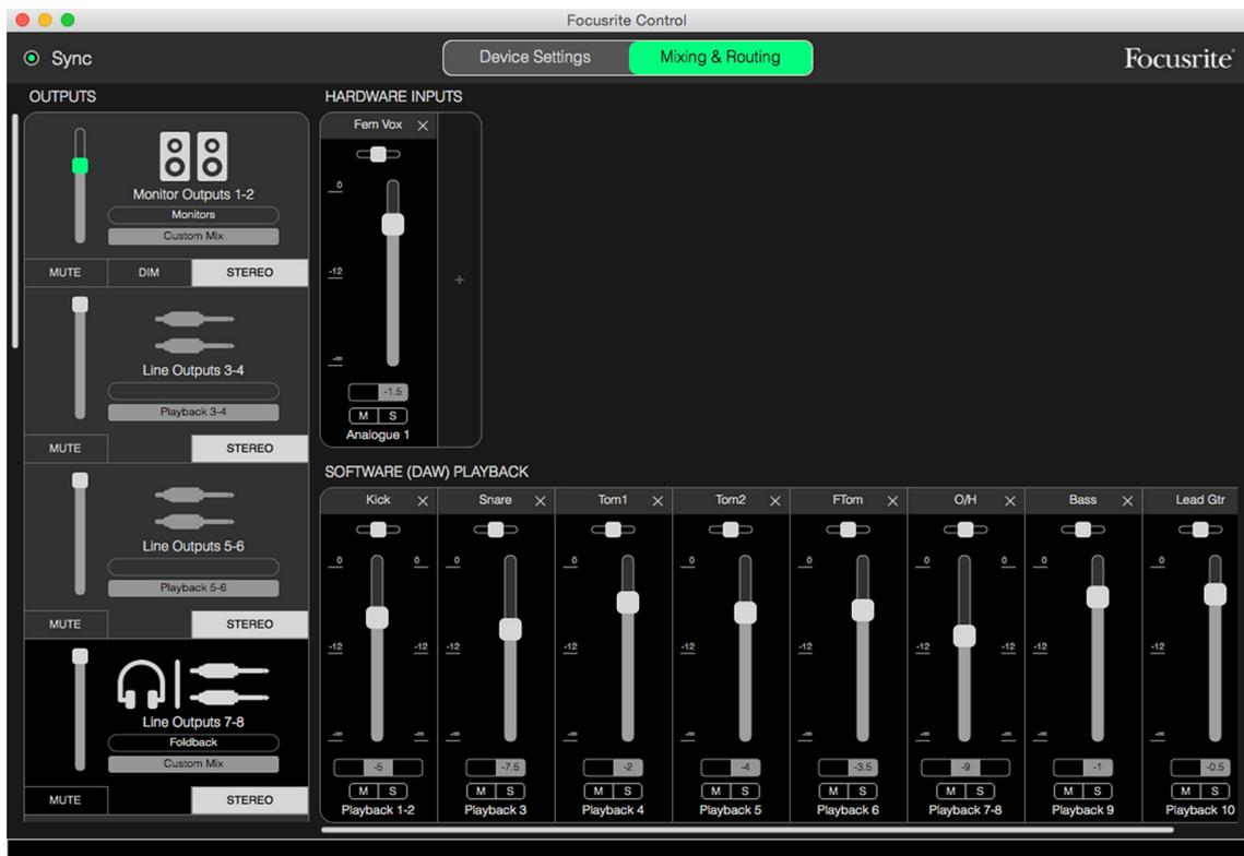
Come con l'esempio del Tracking, il mix iniziale che ascoltate dalle uscite Monitor Outputs e dalle uscite Headphone sarà un mix "grezzo" (i fader sono tutti a zero per default) di tutte le tracce che avete già registrato. È possibile modificare il mix in modo da sentire più o meno forte nelle vostre cuffie lo strumento che state sovraincidendo, o qualsiasi altra traccia (e) pre-registrata.
