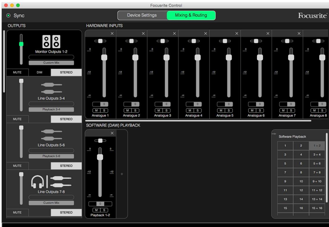
Come per il preset 2 Channel Analogue, l'insieme delle uscite del mixer viene indirizzata alle uscite Monitor 1 e 2 ma anche alle uscite Line Outputs dalla 7 alla 10, come coppia stereo.
